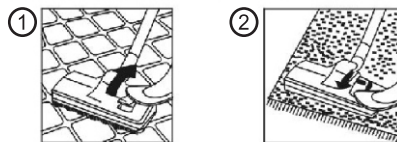
Pos. 1: setole estese per pavimenti duri Pos. 2: setole retratte per tappeti
