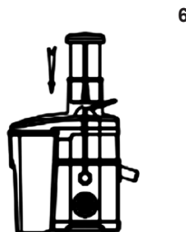
6. Far scorrere il spingitoio verso il basso attraverso il tubo di alimentazione allineando la scanalatura
