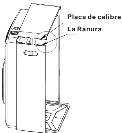
5. PONGA EL PANEL SUPERIOR EN LA PARTE SUPERIOR DEL CALENTADOR Y ENTONCES EMPAREJE LA POSICIÓN
